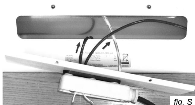
5. Tirez un à la fois les fils d'émetteurs par la plaque à enlever, de la façon illustrée dans la fig. S
