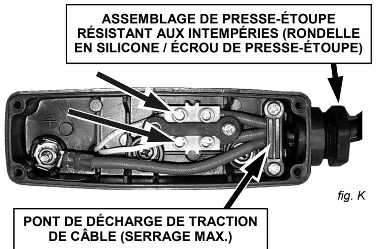
4. Débranchez l'émetteur des plaquettes de connexion, en dévissant les vis indiquées ci-dessus dans la fig. K.
